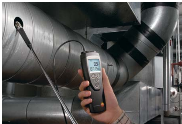
testo 416, np. do pomiarów prędkości i objętości przepływu powietrza w kanałach wentylacyjnych
